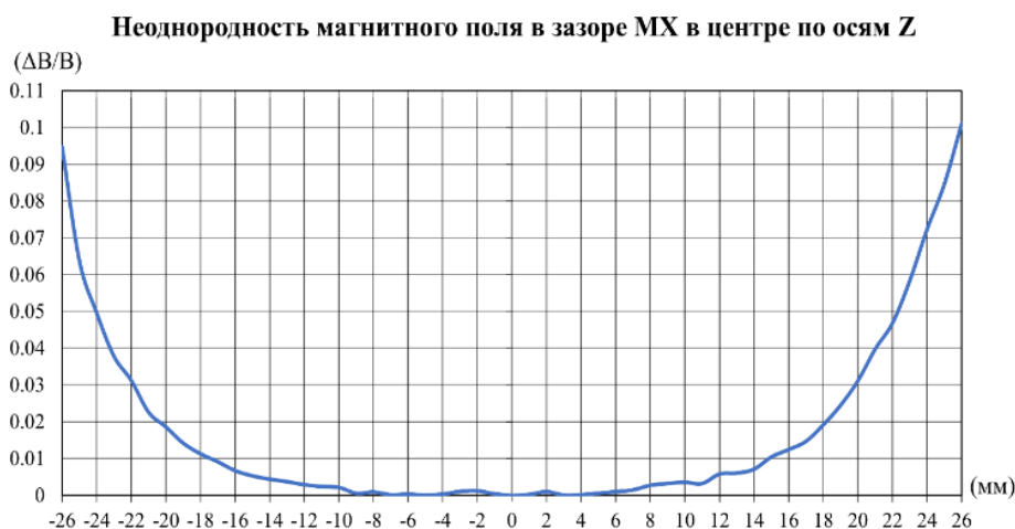
Рис. 3. Значение неоднородности поля \Delta B/B_0 по оси z
