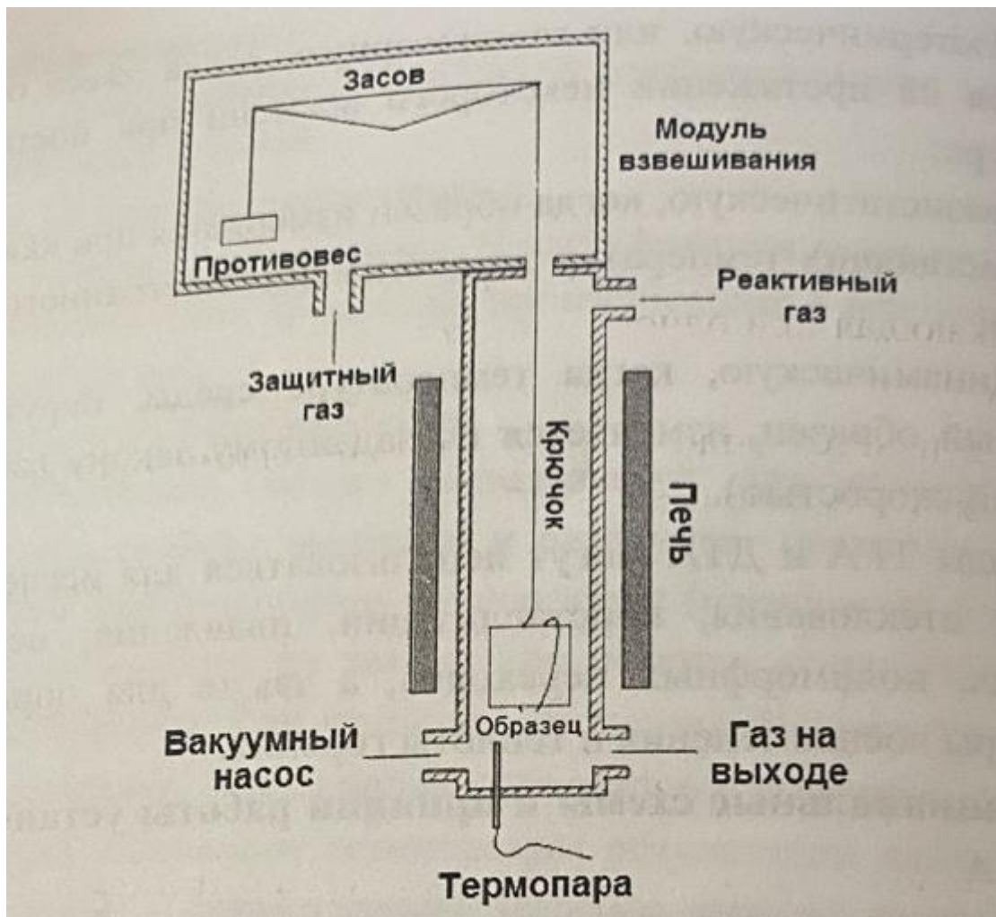
Рисунок 3.1 . Принципиальная схема установки для проведения термогравиметрического анализа
