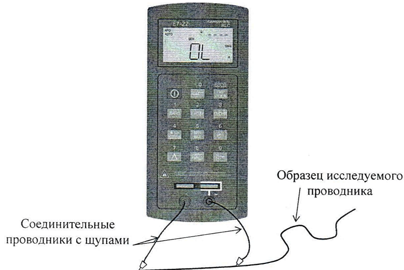
Рис. 1.9. Измерение сопротивления проводника RLC -метром
