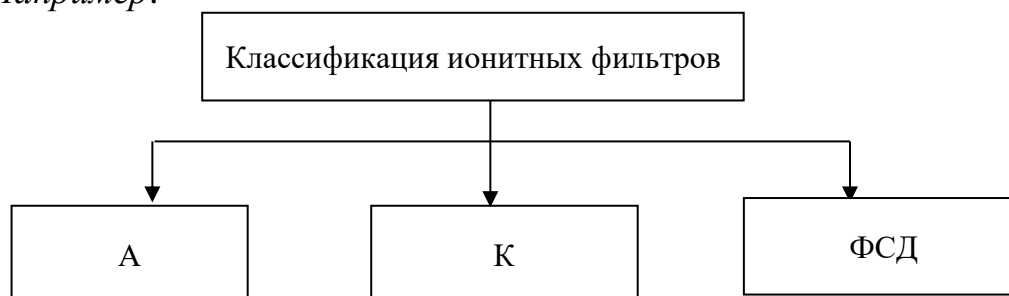
Рисунок 4.1 – Классификация ионитных фильтров: А – анионитные; К – катионитные; ФСД – смешенного действия
