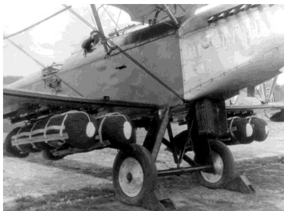
Рис. 5. Мягкие мешки Г-4 на подвеске самолета Р-5
