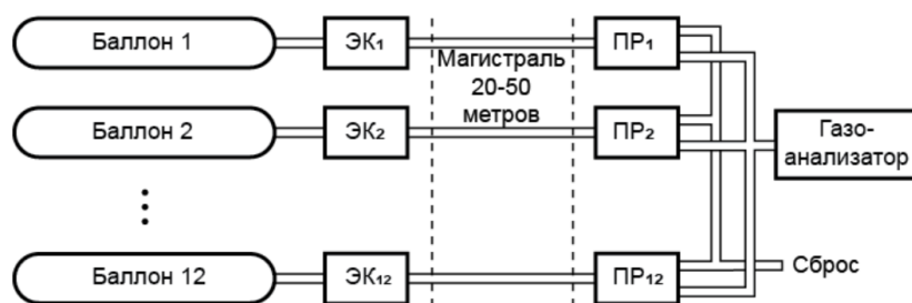
Рис. 2. Схема подключения баллонов к газоанализатору
