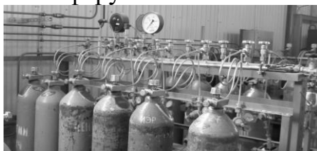
Рис. 1. Площадка с оборудованием для заправки баллонов
