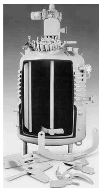
Рис. 2. Классическая технология установки CSTR
