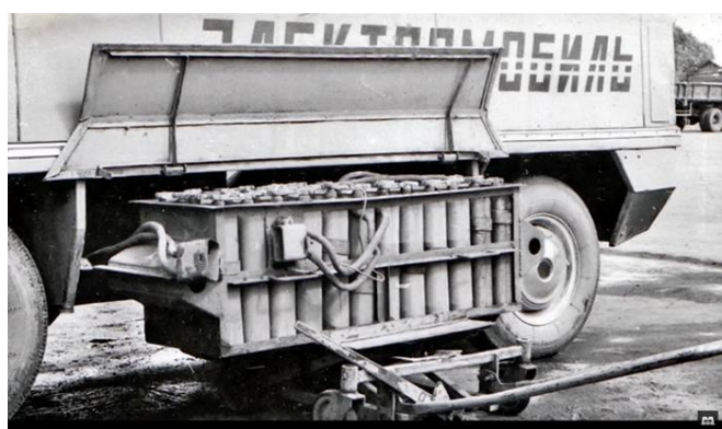
Рис. 1. Почтовый фургон, используемый в качестве ЗС для ЭМ [3]
