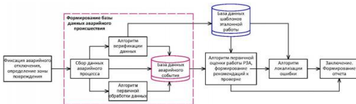
Рис. 1. Структура алгоритма автоматизированной системы мониторинга и анализа работы релейной защиты и автоматики на распределительных подстанциях
