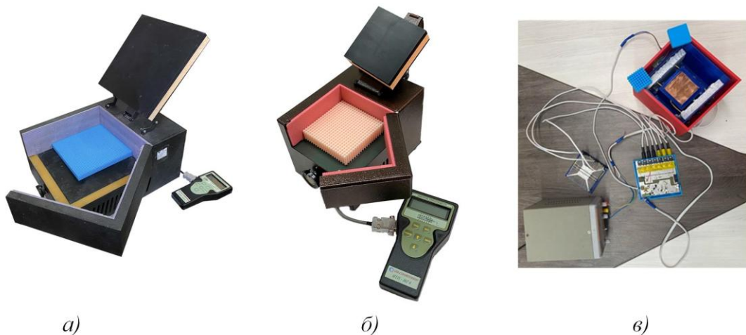
Рисунок 2.5.1. а) ИТП-МГ4 «250»; б) ИТП-МГ4 «100»; в) разработанный лабораторный стенд.
