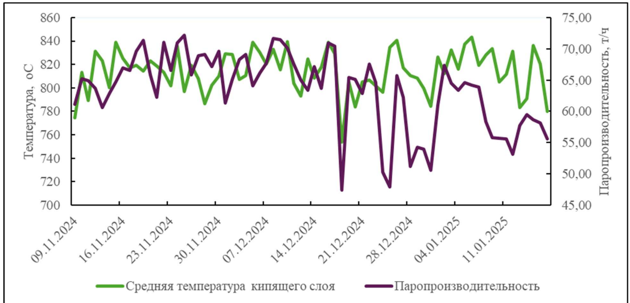
Рисунок 4.21 Паропроизводительность и средняя температура кипящего слоя
