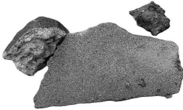
Рисунок 3.2 Агломераты, обнаруженне в донной золе котлоагрегата Е-75-3,9-440 ДФТ
