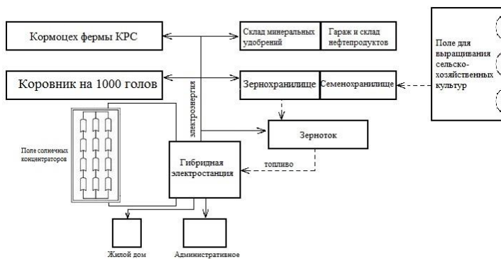
Рисунок 2 – Принципиальная схема энергетического комплекса сельскохозяйственного предприятия
