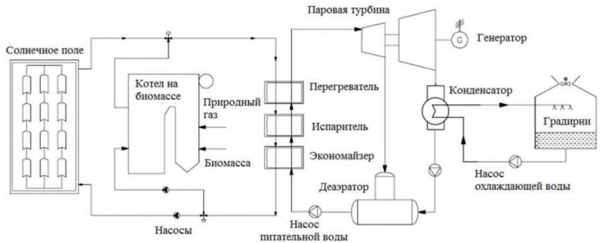
Рисунок 1.4 – Принципиальная технологическая схема электростанции гибридного типа на базе концентрированной солнечной энергии и биомассы [10].
