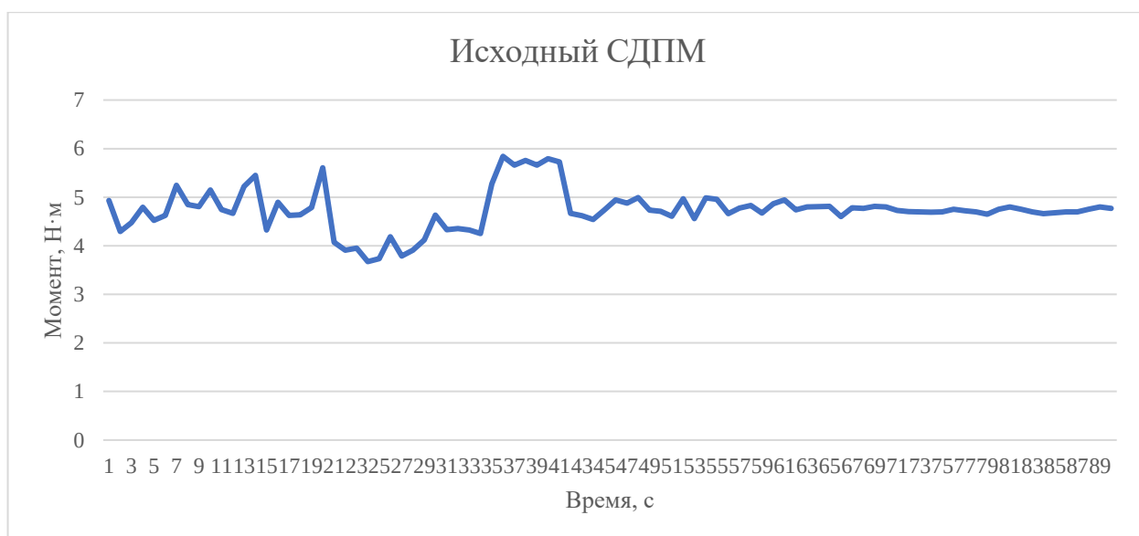
Рисунок 4.24 – Динамика момента при скорости вращения исходного СДПМ 108 об/мин
