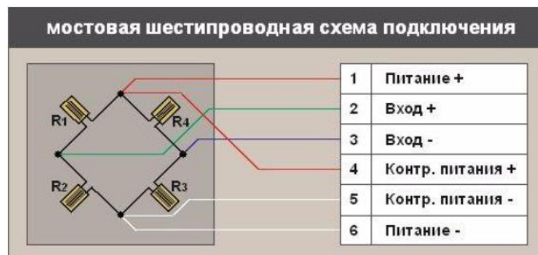
Рисунок 4.18 – Электрическая схема подключения четырех тензорезисторов по мостовой схеме
