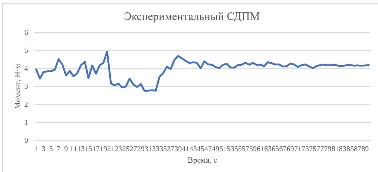
Рисунок 4.25 – Динамика момента при скорости вращения экспериментального СДПМ 107 об/мин
