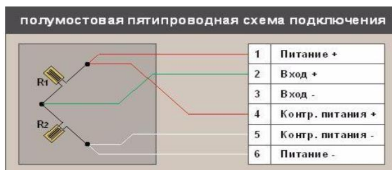
Рисунок 4.16 – Схема подключения тензорезисторов при использовании полумостовой схемы
