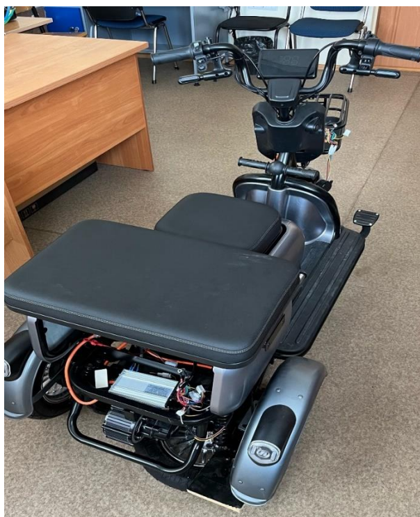
Рисунок 4.20 – Нагрузка (электроцикл), подключаемая к подвижной части стенда
