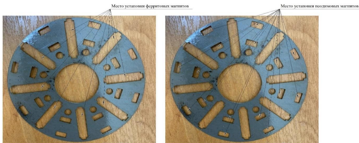
Рисунок 3.11 – Лист электротехнической стали после штамповки (ротор)
