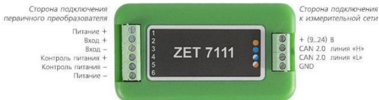
Рисунок 4.15 – Схема подключения цифрового датчика ZET 7111
