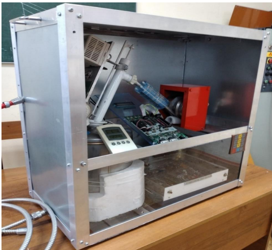
Рисунок 3. 6. Прототип проточного анализатора ПМРА-IV.
