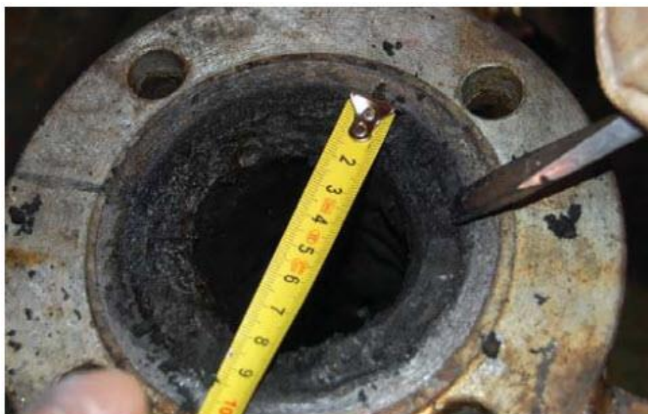
Рисунок 4. 1. Отложение асфальтено–парафинов в нефтепроводах на месторождении Vach Но
