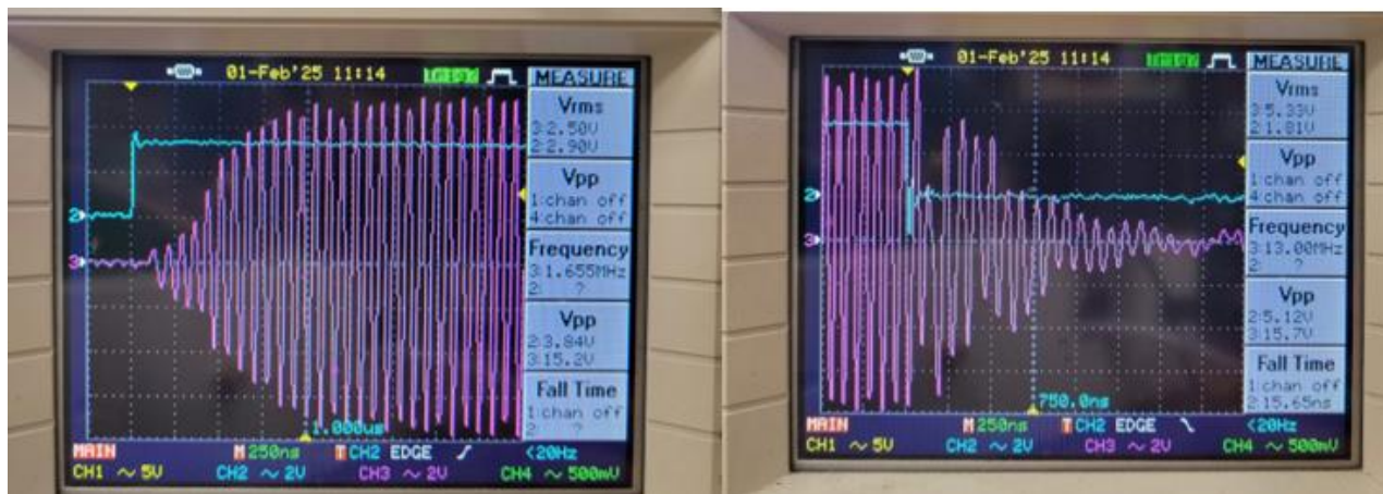
Рисунок 2. 21. Искажение формы импульса поворота на 180^\circ на фронтах при использовании усилителя мощности на универсальных MOSFET –транзисторах
