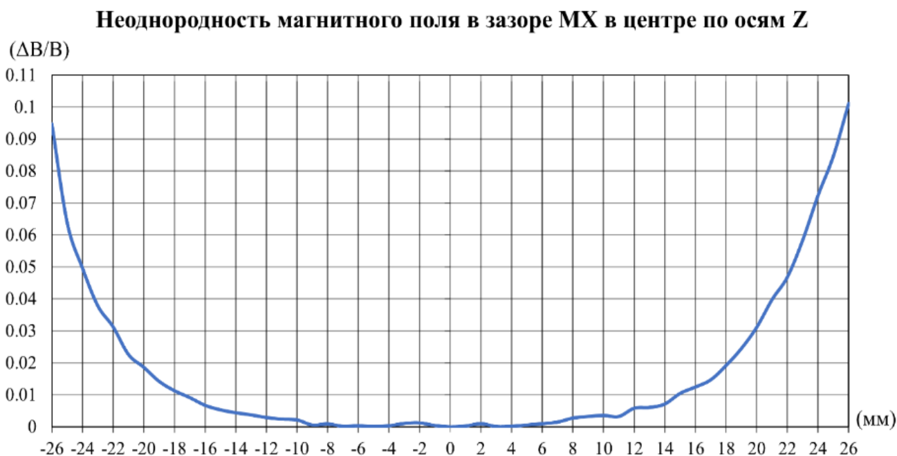
Рисунок 2. 6. Неоднородность магнитного поля в рабочем зазоре МСХ вдоль оси z (вертикальное направление)
