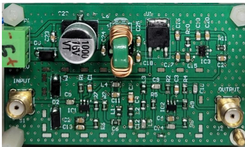
Рисунок 2. 24. Полосовой фильтр и предусилитель для импульсной последовательности КПМГ
