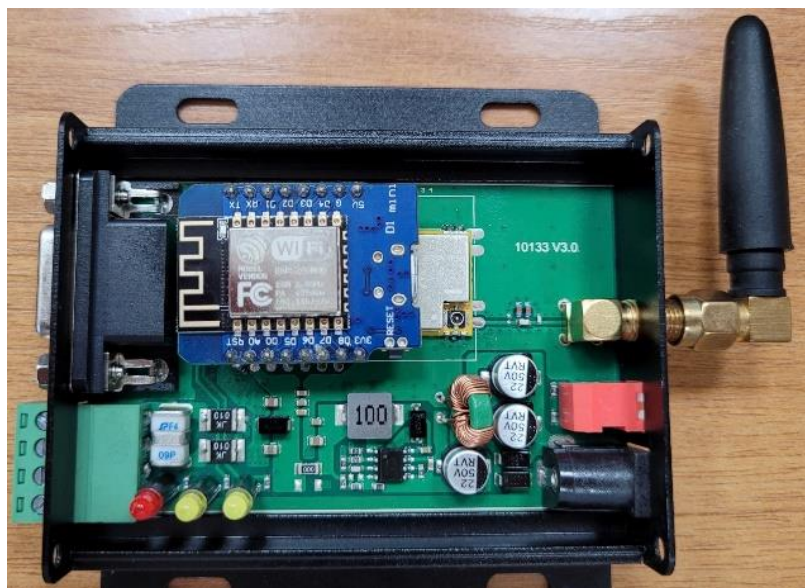
Рисунок 4.13. Приемопередающая станция для подключения релаксометра к ПИВ
