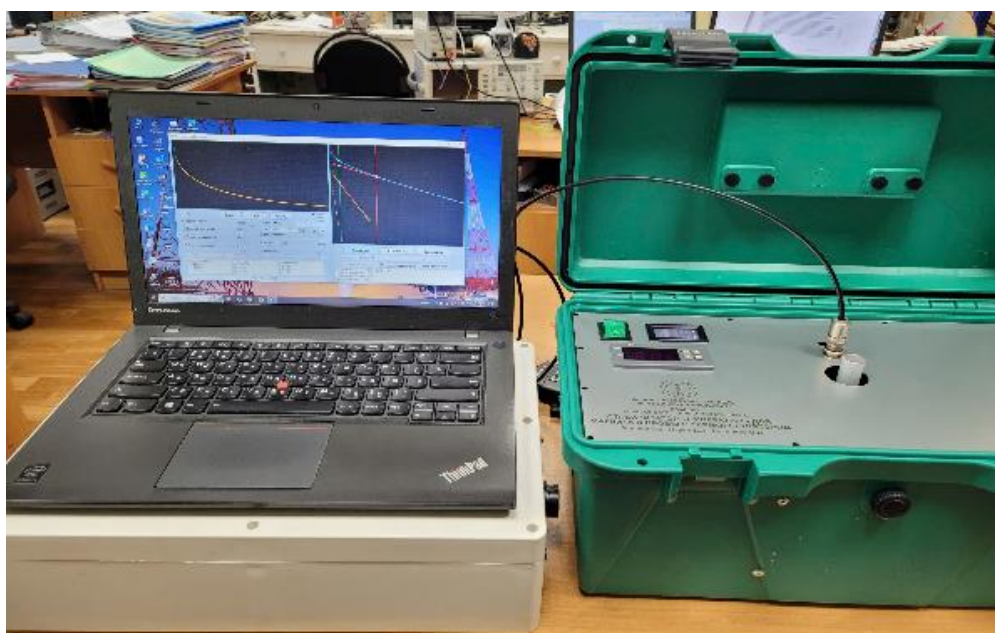
Рисунок 2. 41. Разработанный измерительный комплекс релаксометр ПМР–НРЗ с системой термостатирования магнита Хальбаха.
