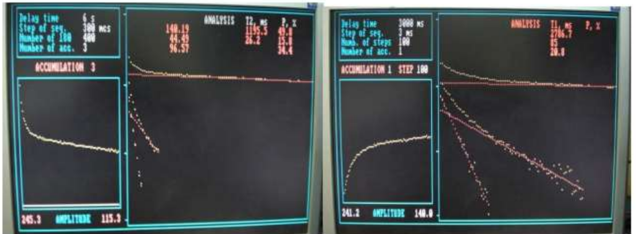
Рисунок 4.2 – Огибающие сигналов спин-эхо (в левой части экрана монитора) и их разложения на компоненты (правая часть) при измерениях времен спин-спиновой T_{2i} , и спин-решеточной T_{1i} релаксации и населенностей протонных фаз P_{1i} и P_{2i} для разных нефтей. Параметры измерений задаются в верхнем левом окне экрана с клавиатуры ЭВМ
