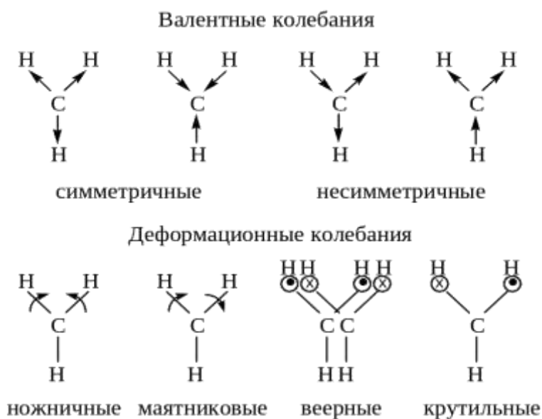
Рисунок 3.9 – Виды и типы колебаний фрагментов и молекул углеводов
