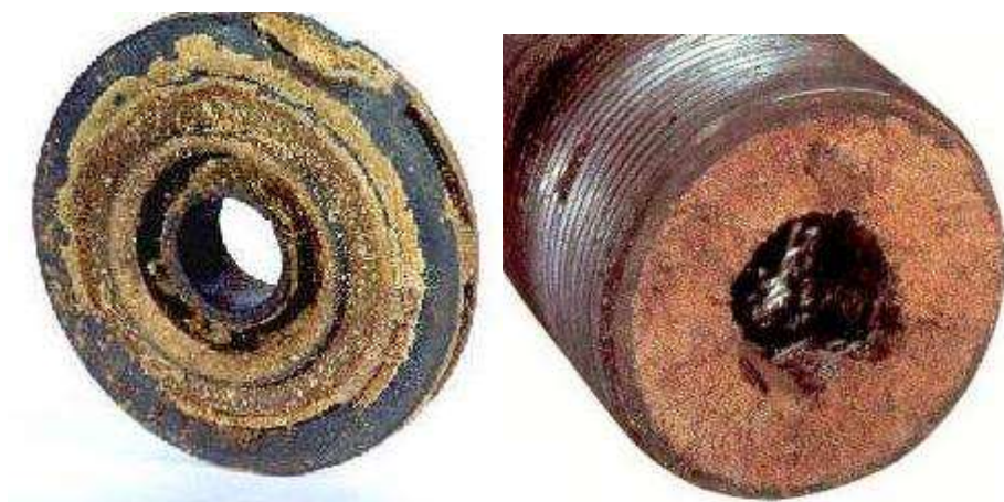
Рисунок В.1 – АСПО в трубопроводе
